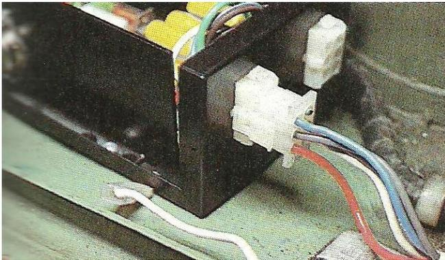
*El cable blanco se conectará mediante un conector faston macho al terminal de masa.*
