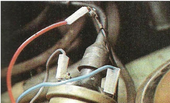
*El cable azul se llevará a la borna de la bobina con la indicación B (+). El cable gris a la otra borna de la bobina.*
