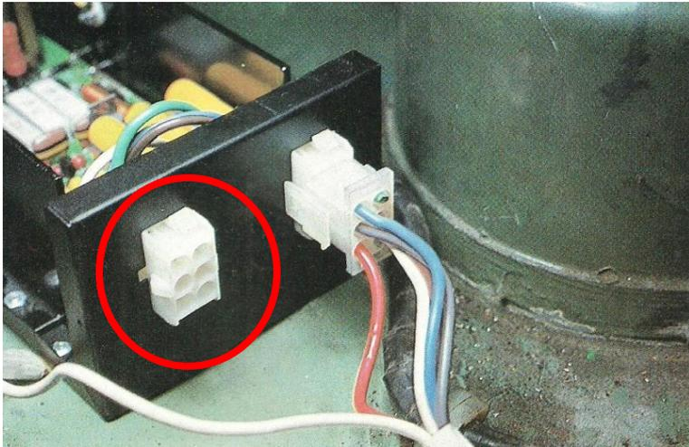
*Conexión hembra que contiene unos puentes preparado para que en caso de necesidad se pueda volver al sistema convencional.*
